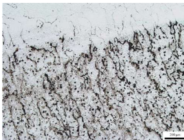
شکل 5- ریزساختار فلز جوش نمونه SL00: (پایین) پاس اول با الکتروود E309L و (بالا) پاس دوم با الکتروود 1600 V.
