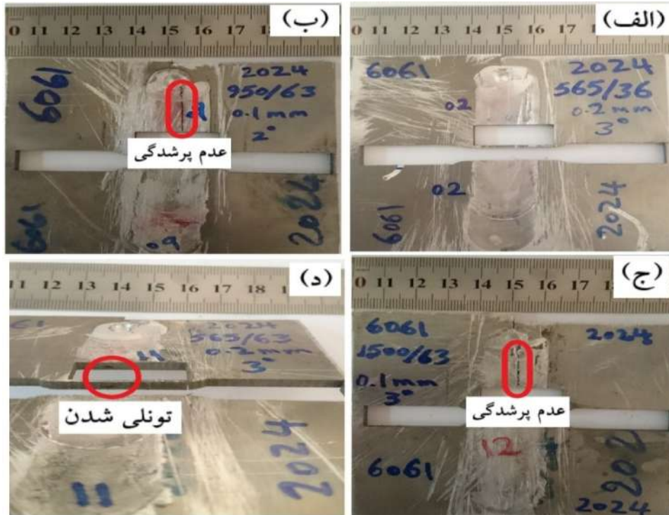
شکل 2- الف- نمونه 2 جوش بدون عیب ب- عیب عدم پرشدگی در نمونه 9، ج- عیب عدم پرشدگی در نمونه 12 و د- عیب عدم پرشدگی و تونلی شدن در نمونه 11
