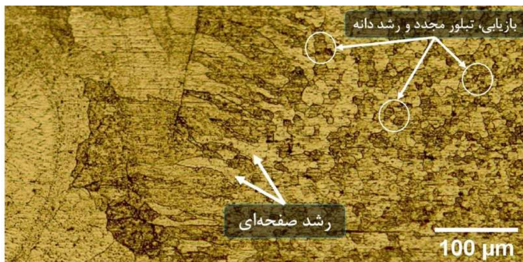
شکل 5- تصویر ریزساختار اتصال در مرز ذوب آلیاژ نیکل تیتانیوم با مدت زمان اعمال پالس 11 میلی‌ثانیه.
