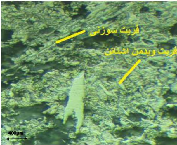
شکل 6- تصویر میکروسکوپی نوری از ریز ساختار منطقه متأثر از حرارت شامل فریت ویدمن اشتاتن و فریت سوزنی.
