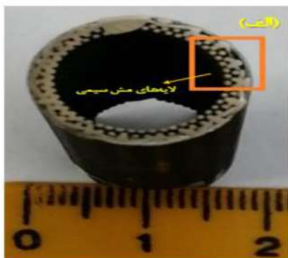
شکل ۲- ترتیب لایه‌ها در مش سیمی سنتر شده ۵ لایه از جنس فولاد زنگ نزن
