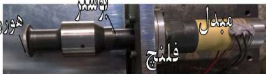
شکل ۲- هورن متصل به بوستر و مبدل آلتراسونیک به همراه فلنج تعبیه شده در نقطه گره
