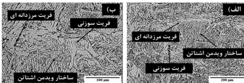
شکل ۵- ریزساختار اتصال غیرهمجنس فولاد Corten A الف- بزرگنمایی ۱۰۰X ب- بزرگنمایی ۲۰۰X
