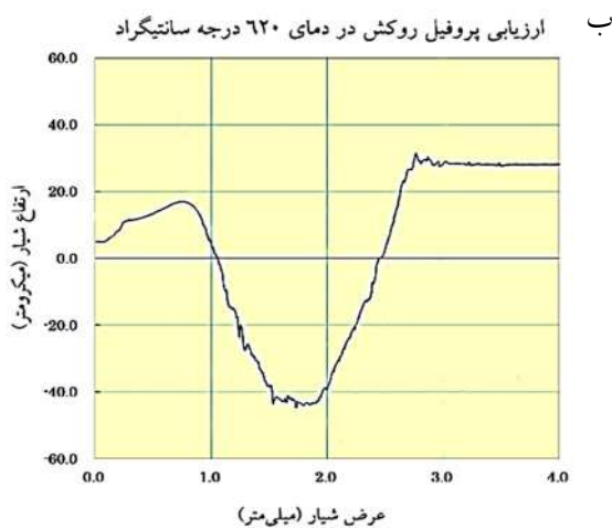
شکل 6- عمق نفوذ و عرض ناحیه سایش زیرلایه و روکش در دمای 620 درجه سانتیگراد.
